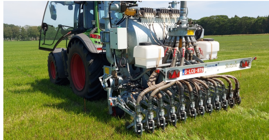
Proefveldmachine voor toediening o.a. gierfracties (ook giften 5-15 m 3 /ha mogelijk)
