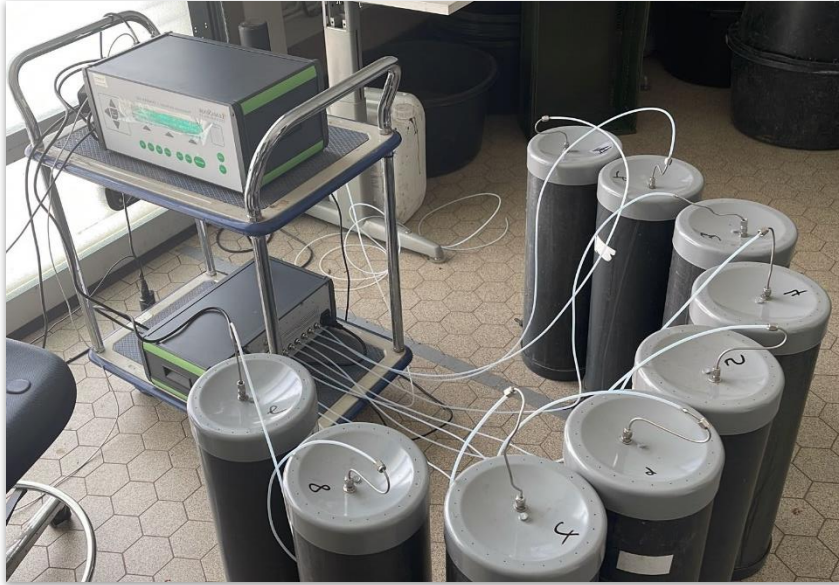
Figuur 2. Gesloten vaten via deksel verbonden met de multisampler Innova 1409 en multigasanalyser Innova 1512.
